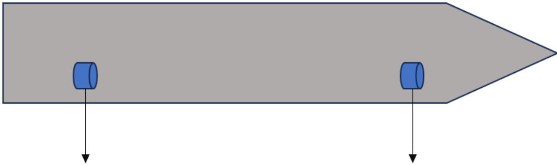
Figura 14: Desenho de navio com seus cabos de travessas.
