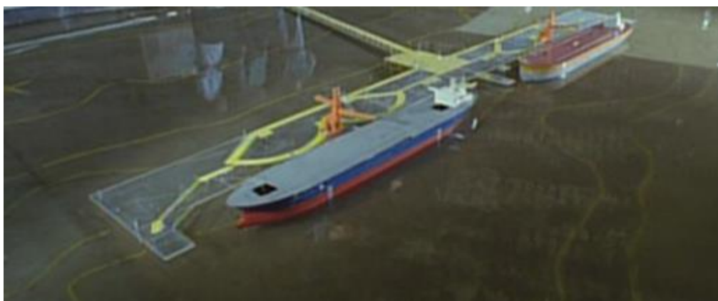
Figura 2: Modelo reduzido da embarcação utilizado para testes.
