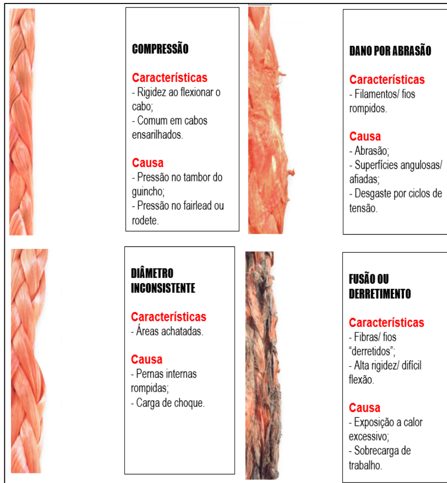
Figura 4: Condição dos cabos de terra de HMPE.
