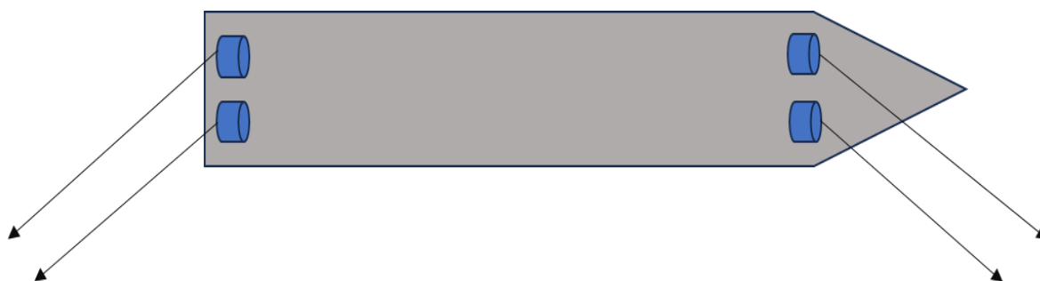
Figura 13: Desenho de navio com seus cabos de lançantes.
