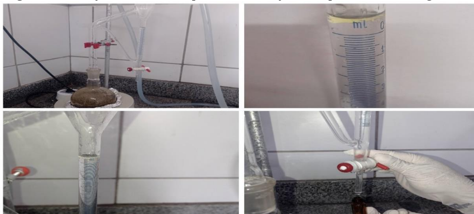
Figura 6: Produção de Hidrolatos por hidrodestilação em Aparelho de Clevenger.
