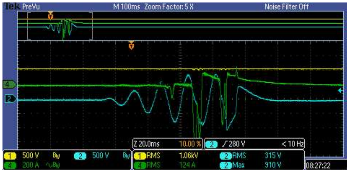
Figura 6.28 – Energização de um transformador de 1 MVA com rampa de tensão do BESS: (a) rampa de 30 ms; (b) rampa de 50 ms.
