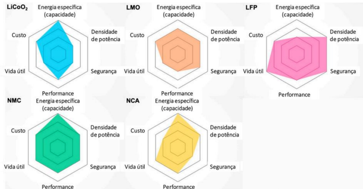
Figura 2 – Comparação entre os diferentes tipos de cátodos para aplicação em baterias de íon de lítio usadas atualmente. Nas pontas de cada hexágono (lendo no sentido horário) temos as seguintes perspectivas: energia específica (capacidade), potência específica, segurança, desempenho, vida útil e custo. Quanto mais próximo da ponta cada perspectiva estiver, mais desejável para a aplicação comercial o material é sob essa perspectiva.
