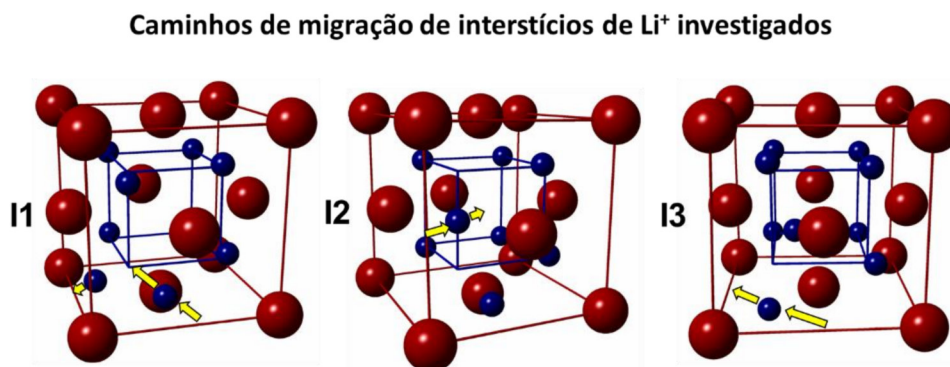
Figura 41 – Caminhos de migração de interstício \text{Li}^+ investigados para o \text{Li}_2\text{S} . A energia de Gibbs de migração dos respectivos caminhos está em ordem crescente de energia e é dada pela seguinte sequência: g_{I1}^m < g_{I2}^m < g_{I3}^m .
