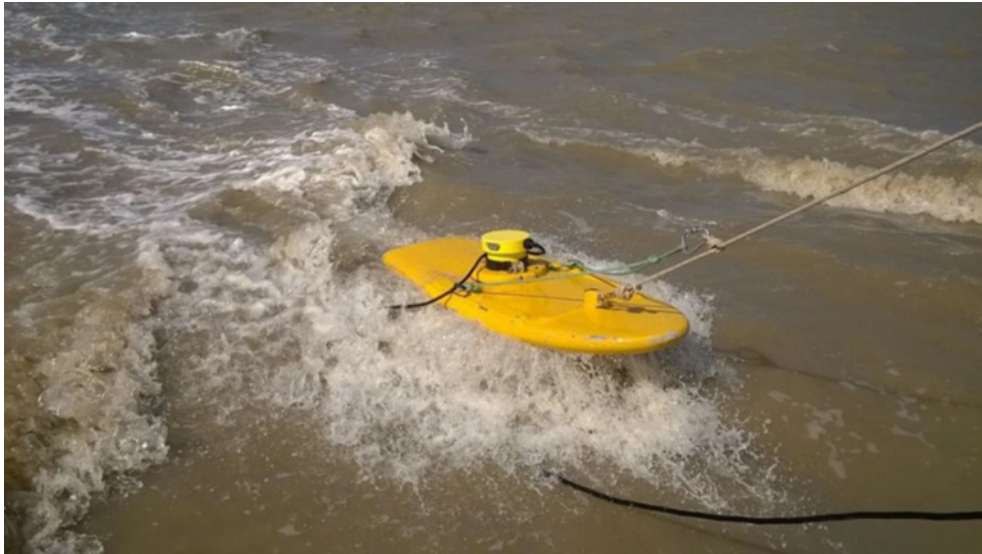
Figura 9: ADCP acoplado à prancha, rebocado na popa da embarcação. Fonte: Silva (2016).
