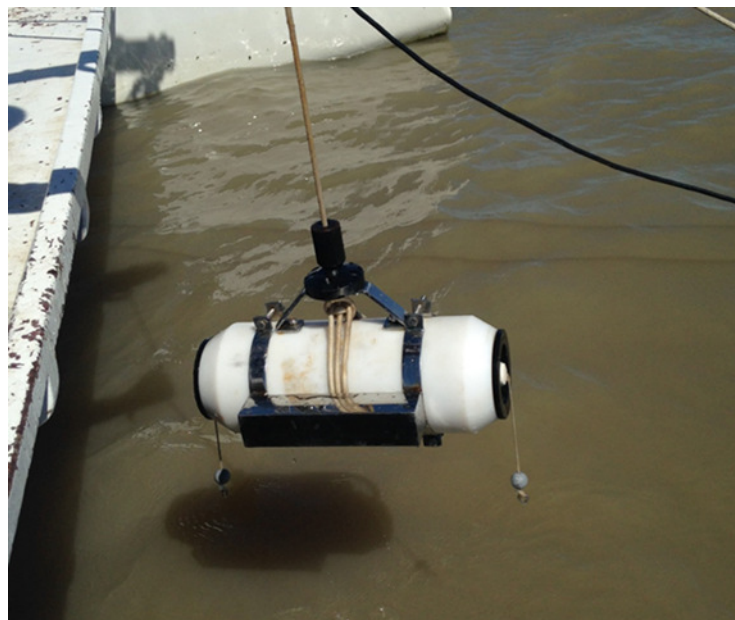
Figura 12: Garrafa de Van Dorn utilizada para coleta de água para aquisição do MPS na área de estudo. Fonte: Autora.
