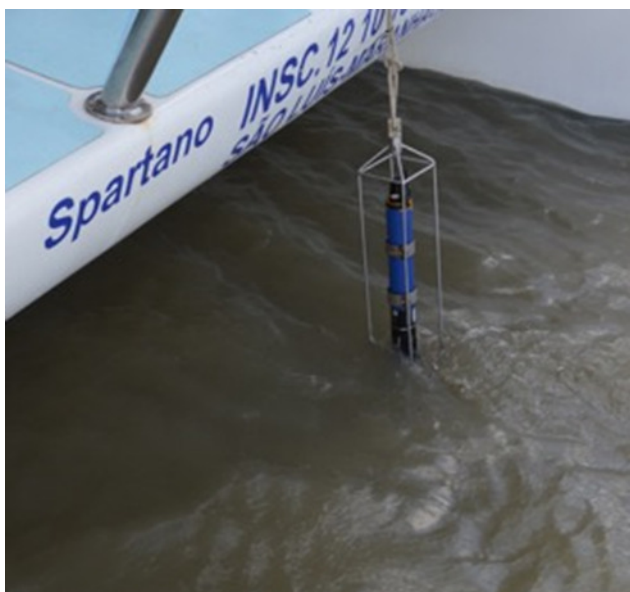
Figura 11: CTD/EXO2, com grade de proteção.
