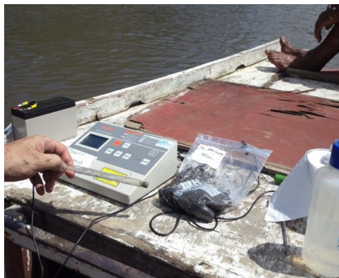
Figura 9 - Análises de pH e Eh in situ no local da coleta
