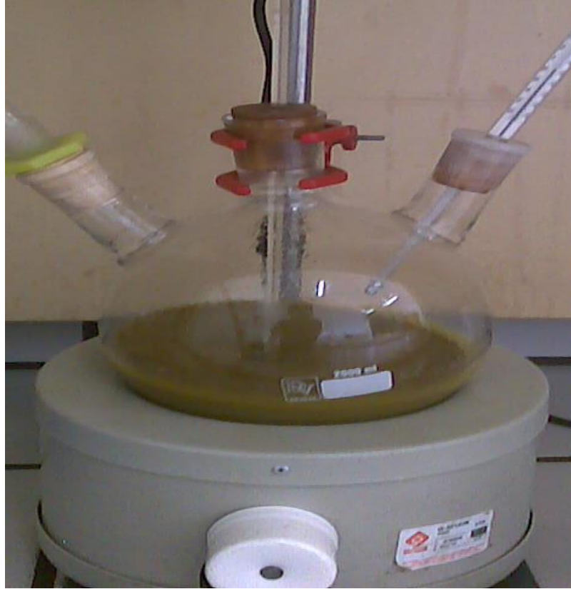
Figura 1. Esquema utilizado no procedimento do tratamento ácido da zeólita maranhense.
