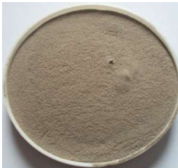
Figura 3. Foto da argila maranhense tratada com ácido clorídrico 4,0 mol L -1 a temperatura de 90 °C por 2,0 h.
