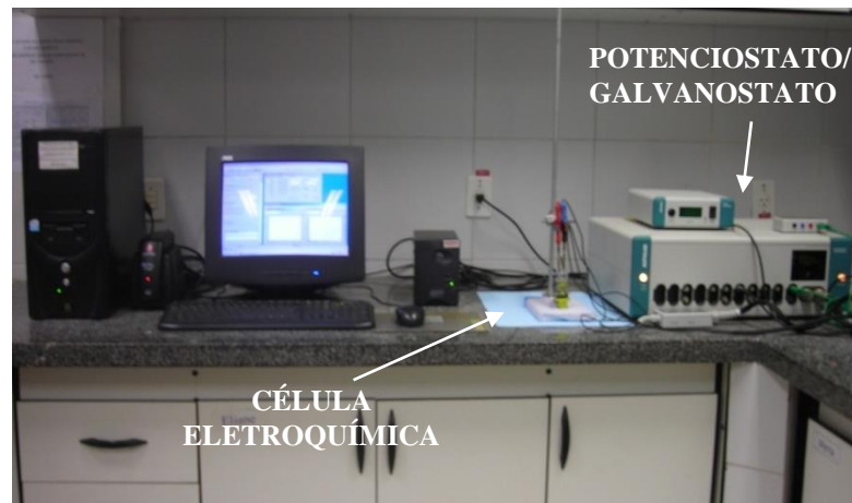
Figura 10 – Arranjo do Potenciostato/Galvanostato AUTOLAB (Eco Chemie), Mod PGSTAT30, conjugado a um analisador de frequência, FRA 4.9 utilizado nos testes de espectroscopia de impedância eletroquímica.
