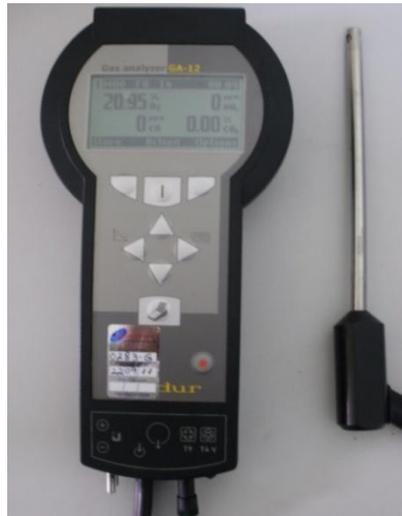
Figura 11 – Analisador de gases TEC-GA 12.
