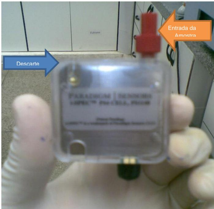
Figura 4 - Entrada e saída da amostra no sensor I-SPEC
