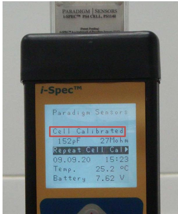
Figura 5 - Teste de calibração dos sensores
