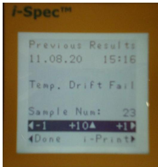
Figura 16 - Status de erro quando não há estabilização na temperatura de análise.
