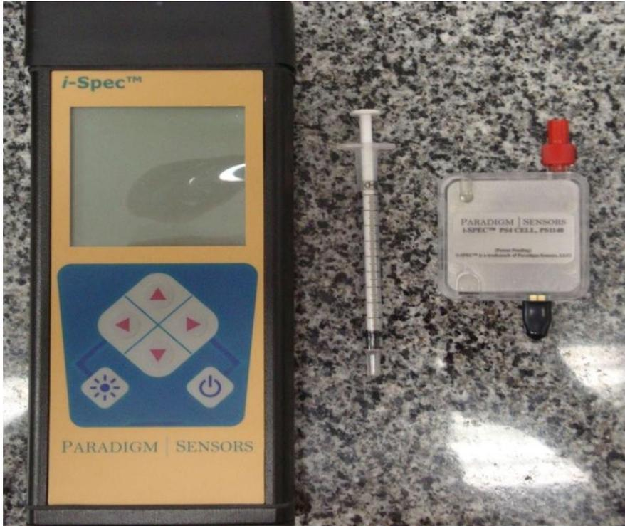
Figura 1 - Conjunto I-SPEC: Leitor, Sensor e Seringa
