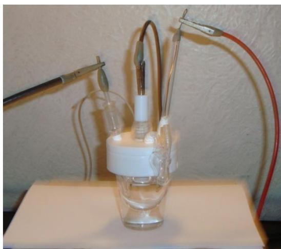
**Figura 3:** Célula utilizada para as medidas eletroquímicas.
