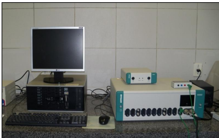
Figura 4. Sistema eletroanalítico AUTOLAB PGSTAT acoplado ao computador.
