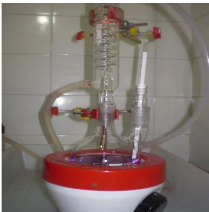
Figura 2.1: Sistema de refluxo montado para a síntese dos eletrocatalisadores Pt/C, PtRh/C (50:50), PtRh/C (67:33), PtRh/C (75:25), PtMo/C (50:50), PtMo/C (67:33), PtMo/C (75:25), PtRhMo/C (50:37,5:12,5), PtRhMo/C (50:25:25) e PtRhMo/C (50:12,5:37,5), empregando-se o método da redução por álcool.
