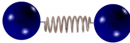
Figura 4: Modelo de um oscilador harmônico, duas massas m_1 e m_2 conectadas por um fio de constante de força f .
