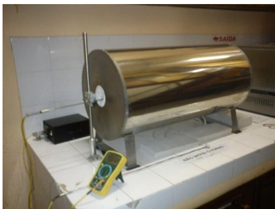
Figura 13 - Forno tubular utilizado nos processos isotérmicos.
