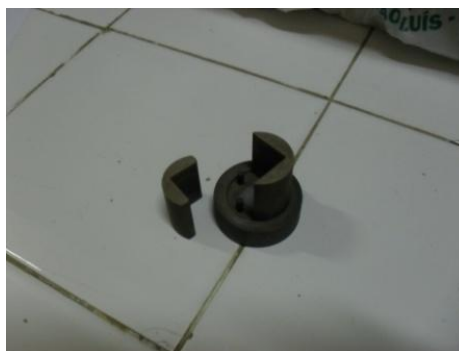
Figura 11 – Molde de latão utilizado no processo de moldagem das amostras
