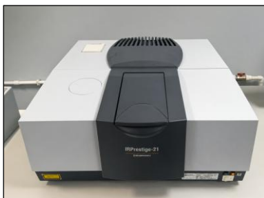
Figura 33 - Espectrômetro do infravermelho do laboratório CAMQ
