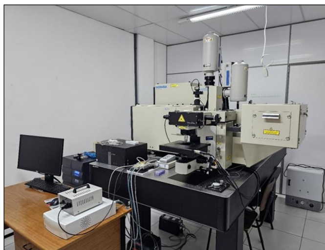
Figura 32- Espectrômetro Raman do LEVI
