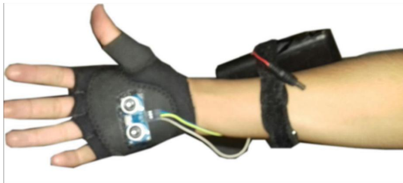
Figura 1 – Protótipo da luva sensorial construída com Arduino
