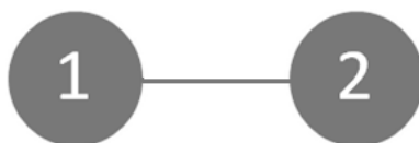
FIGURA 3.20: Cadeia com dois guias acoplados linearmente, CA02 . A entrada do pulso é no guia 1.
