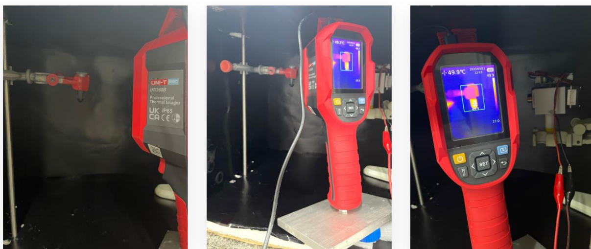
Figura 5 – Infraestrutura do teste fototérmico, sendo (a) câmera posicionada na direção da amostra no ependorf , (b) início do ensaio com LED acionado incidindo na amostra com câmera captando imagem, (c) registrando a variação de temperatura.
