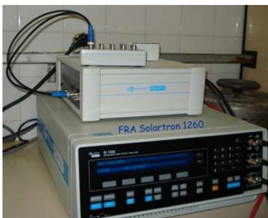
Figura 14: Analisador de respostas em frequência (FRA), modelo 1260, acoplado a uma interface dielétrica, modelo 1296 (para ampliação na sua janela espectral), ambos da marca Solartron.
