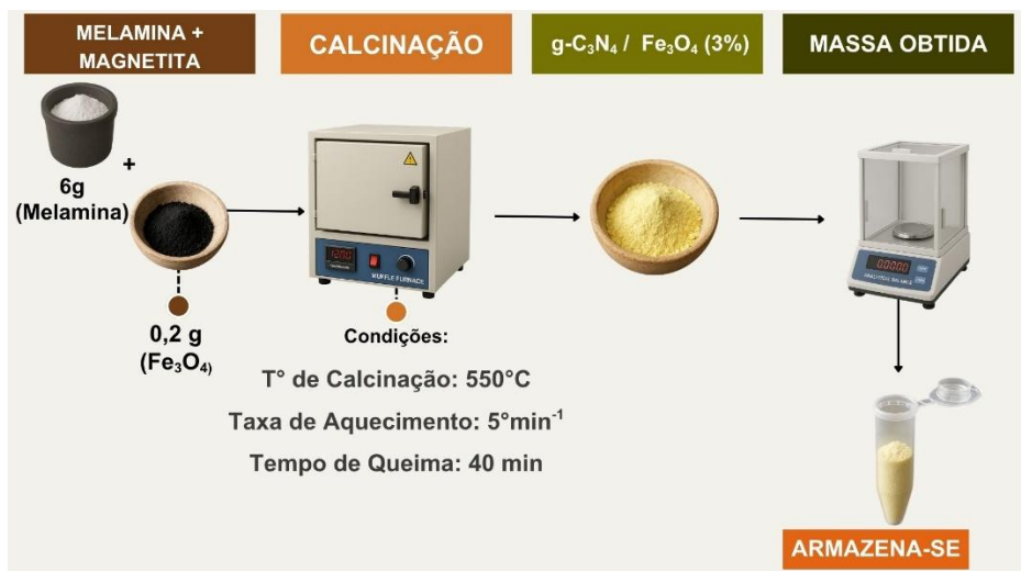
Figura 5 - Síntese do composto magnético g-C 3 N 4 / Fe 3 O 4 (3%) com g-C 3 N 4 obtido a partir da melamina
