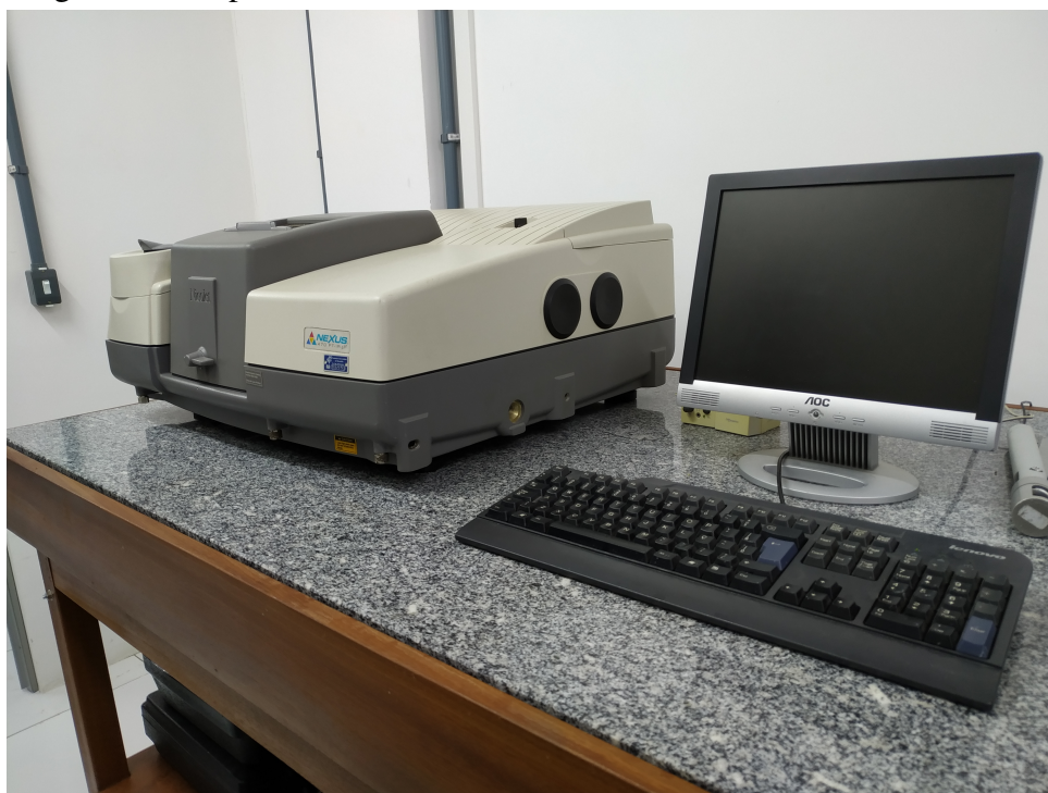
Figura 22 – Espectrômetro Thermo Nicolet NEXUS 870 ESP FT-IR/NIR
