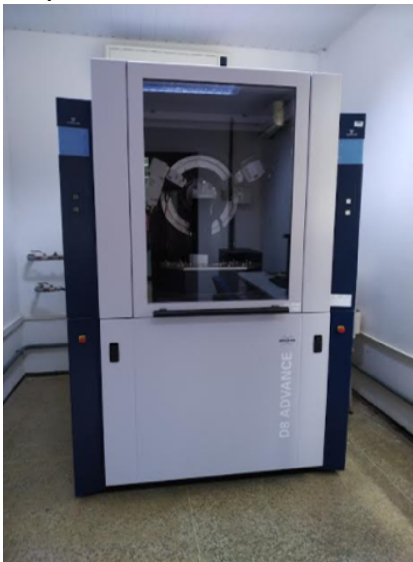
Figura 19 – Difratômetro de raios X Bruker D8 Advance
