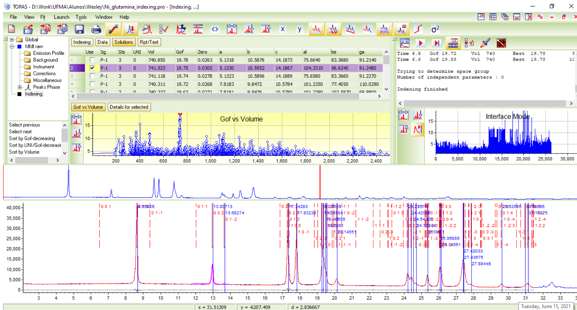
Figura 32 – Interface do programa TOPAS mostrando a indexação dos picos e a solução P-1
