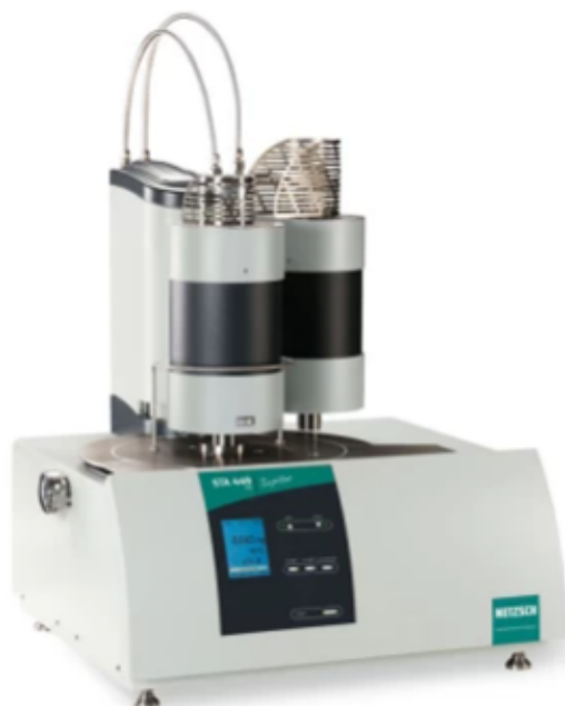
Figura 21 – Analisador térmico simultâneo STA 449 F3, modelo Jupiter da marca Netzsch
