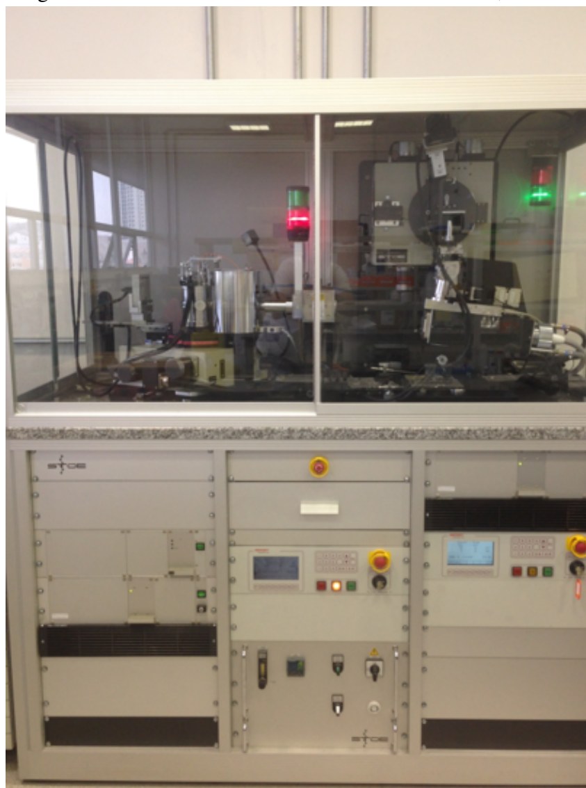
Figura 20 – Difratômetro de raios X modelo STADI-P, da Stoe.
