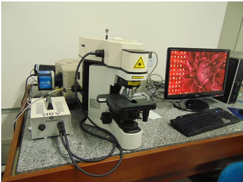
Figura 23 – Espectrômetro Raman Horiba modelo iHR550, CCD e microscópio
