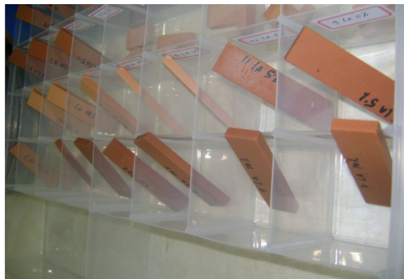
Figura 6. Corpos de prova após o ensaio da Balança Hidrostática.
