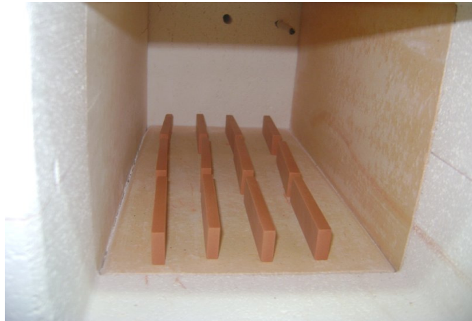
Figura 14. Disposição dos corpos de prova dentro do forno mufla.
