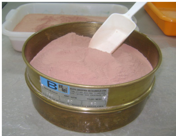
Figura 8. Processo em peneira com 0,250 mm de abertura.
