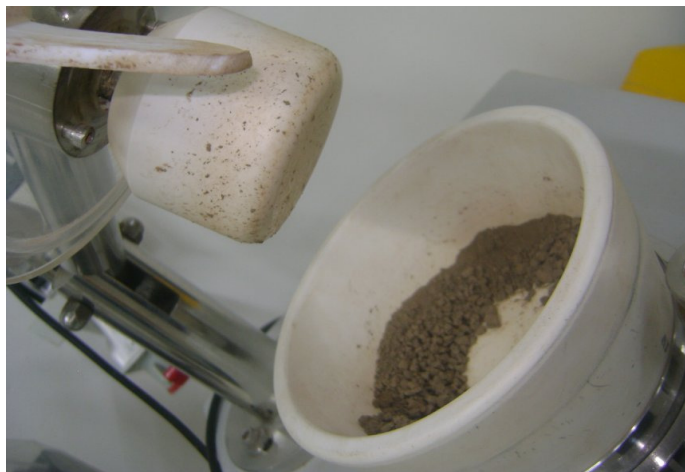
Figura 10. Porção de lodo no processo de moagem.
