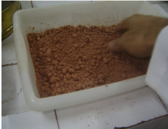
Figura 9. Processo de homogeneização manual da água na argila.
