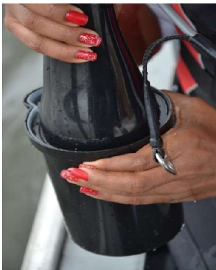
Figura 34 - Coleta da amostra e acoplamento da sonda
