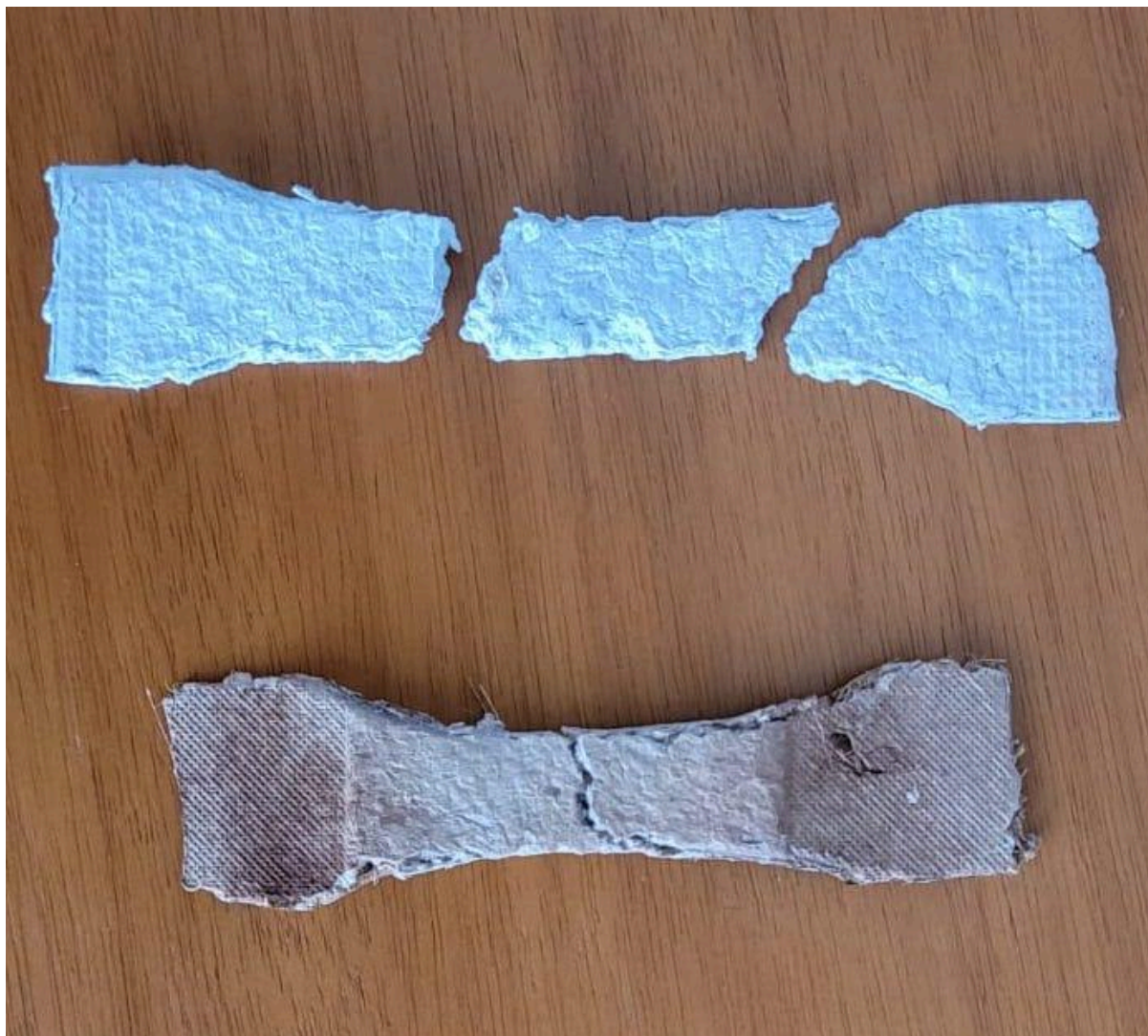
Figura 41 - Imagem ilustrando o estado do corpo de prova sem aditivos após a finalização do segundo ensaio (acima) e o estado dos corpos de prova intermediários após o mesmo ensaio (abaixo).
