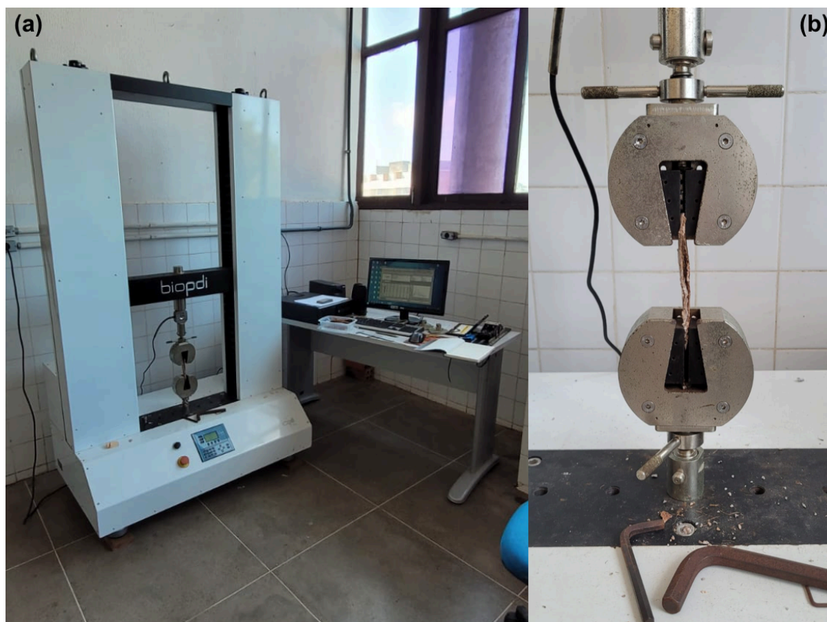
Figura 38 - Mosaico com imagens ilustrando (a) a Máquina Universal de Ensaios Biopdi MBIO-II no laboratório de testes do Departamento de Design, (b) uma das amostras fixada nas garras da máquina no início do teste.
