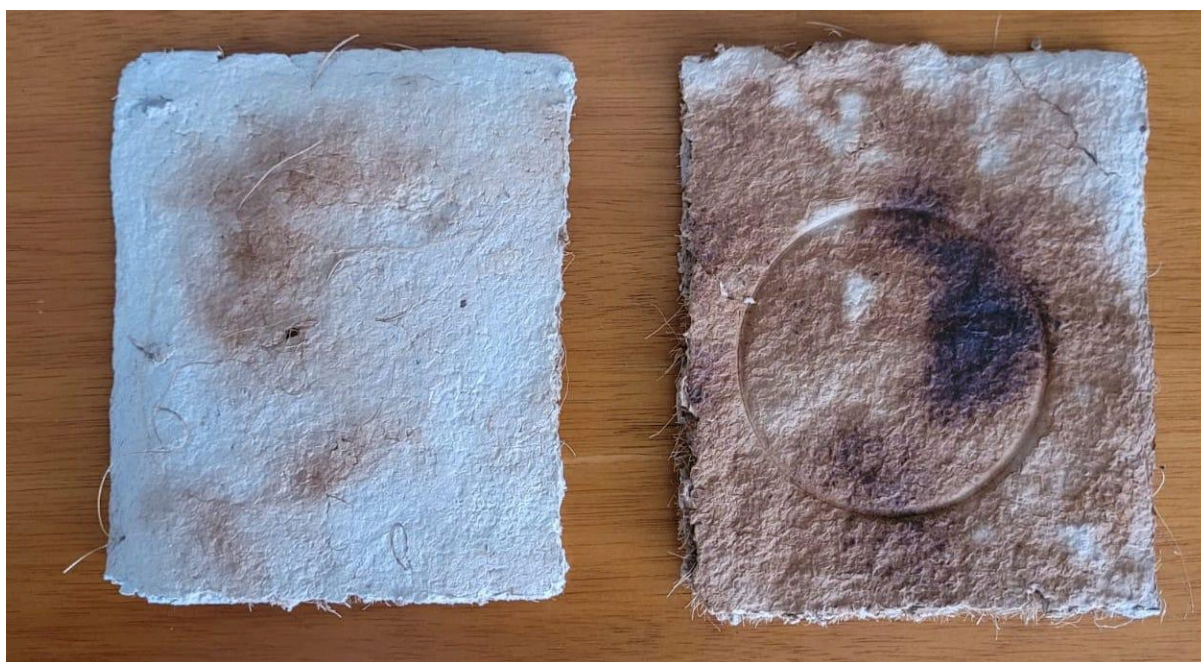
Figura 40 - Imagem ilustrando o antes e depois das amostras após o primeiro teste - sendo o “depois” a amostra da direita com a marca do cilindro metálico pressionado contra a superfície da amostra.
