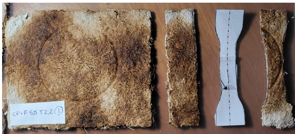
Figura 36 - Imagem ilustrando as etapas da transformação da amostra da sua forma inicial até o seu formato final em “gravata”.
