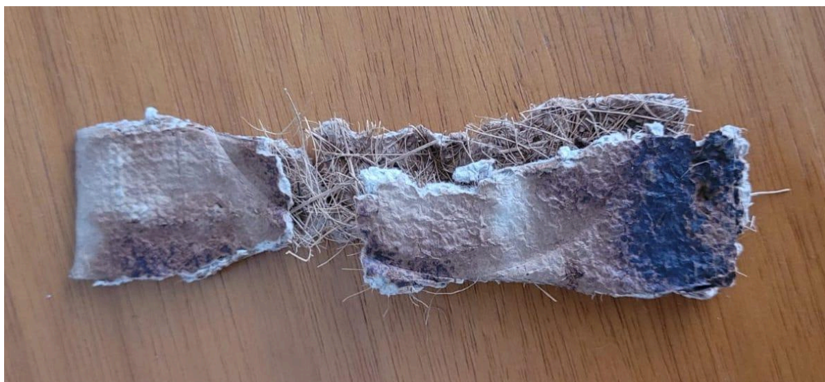
Figura 42 - Imagem ilustrando o estado do corpo de prova com a maior proporção de aditivos após a finalização do segundo ensaio.
