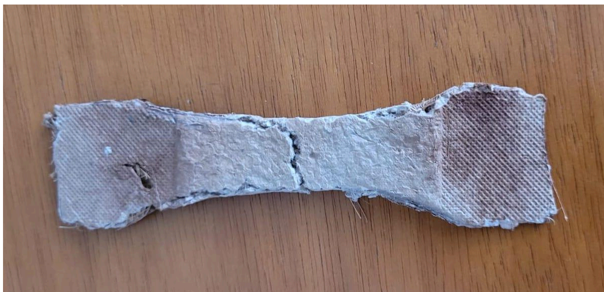
Figura 43 - Imagem ilustrando o estado de um dos corpos de prova intermediários após a finalização do segundo ensaio.
