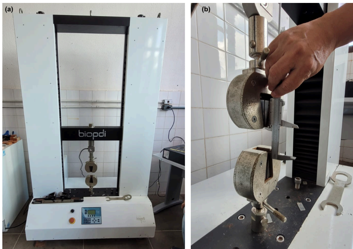
Figura 24 - Mosaico de imagens ilustrando (a) Equipamento Biopdi MBIO-II no laboratório do Departamento de Design da UFMA e (b) garras utilizadas para fixação dos corpos de prova.
