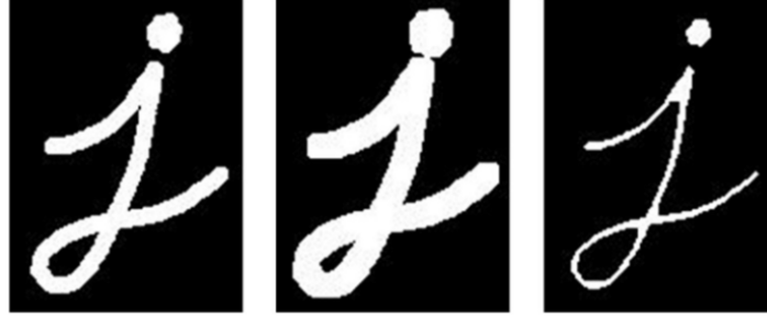
Figura 20 – Na figura à esquerda, a imagem original. No centro, após a aplicação da operação de dilatação na imagem original. À direita, após a aplicação da operação de erosão.
