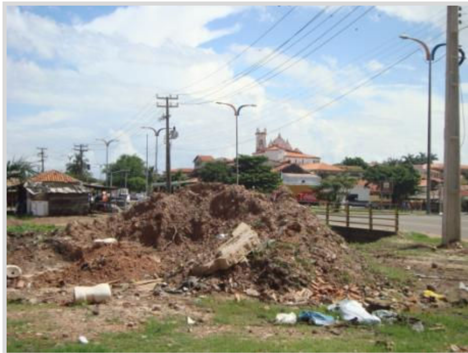
Foto 9 – Local de descarte irregular de resíduos da construção civil – no Aterro do Bacanga: resíduos de terraplenagem misturados com materiais cerâmicos e louças sanitárias. (18/07/2014)
