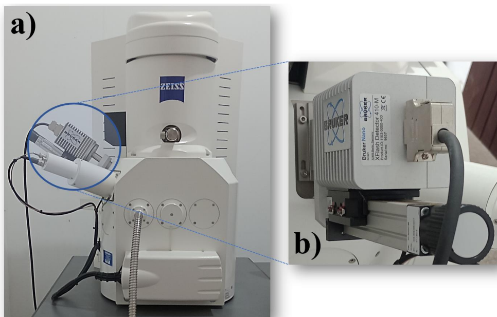
Figura S2. a) Microscópio eletrônico de varredura Zeiss , modelo EVO 15 e b) detector EDS da Bruker , modelo XFlash 410-M .
