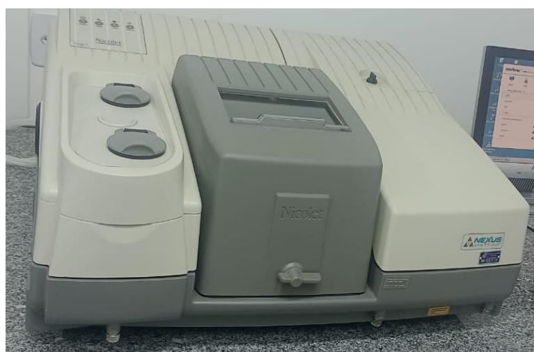
Figura S3b. Espectrômetro FT-IR da Nicolet , modelo Nexus 470 .
