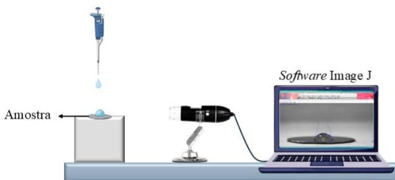
Figura 14. Aparato experimental para medição de molhabilidade: medição do ângulo de contato do líquido sobre a amostra com auxílio de um microscópio digital USB e do software Image J. Fonte: elaborado pelo autor.
