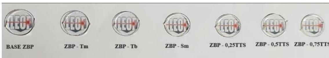
**Figura 21.** Fotografia de fatias das amostras sintetizadas após etapas de corte e polimento óptico.
