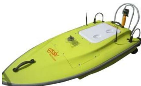
Figura 4. Embarcação portátil não tripulada, operado via rádio. (Figura do autor).
