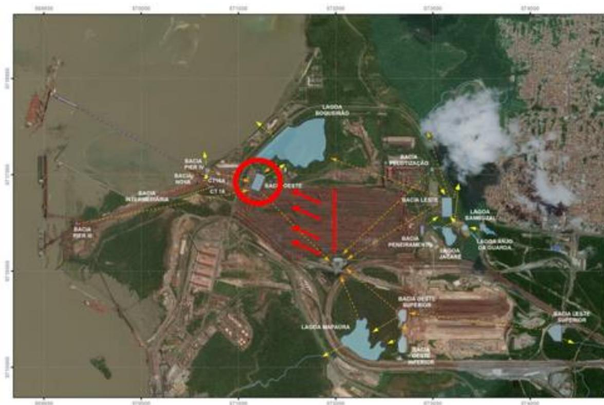
Figura 24 – Em destaque a CT5, circulado em vermelho que recebe contribuição direta dos pátios de estocagem. (Figura do autor).
