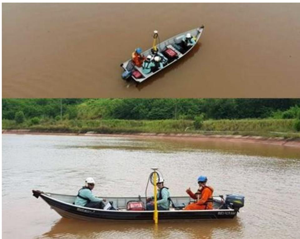
Figura 3. Realização de levantamento batimétrico até o ano de 2019. (Figura do autor).
