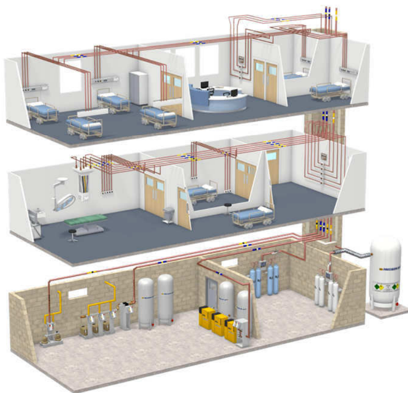
Figura 6: Representação esquemática do fornecimento dos gases medicinais numa unidade de saúde.
