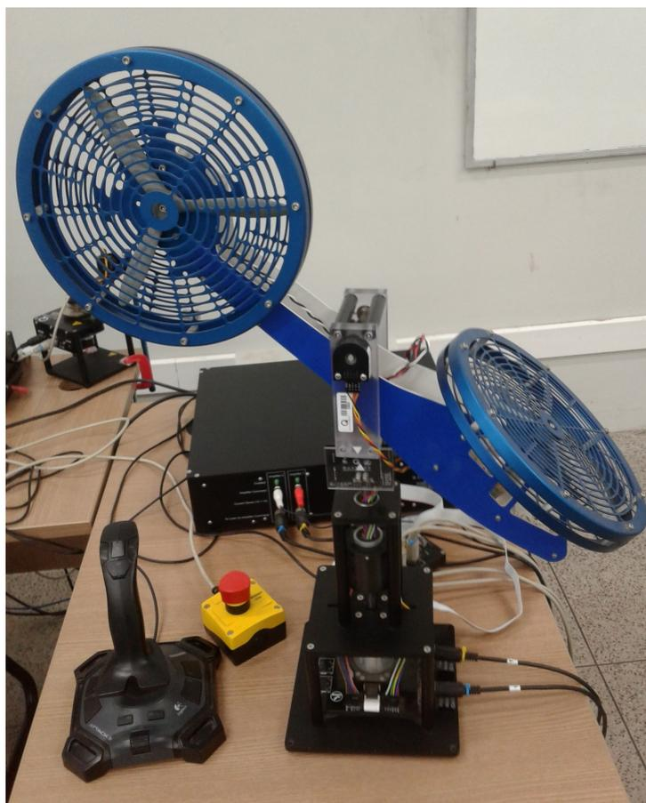
Figura 84 – Sistema dinâmico MIMO referente ao helicóptero 2DoF. Fonte: Elaborado pela autora.
