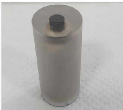
**Figura 1-** Eletrodo de disco rotatório a base de carbono vítreo (CV) construído com resina epóxi.
