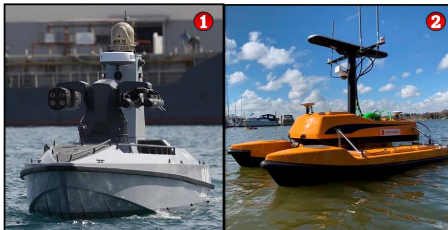
Figura 3.2 – Configurações de cascos de USVs: casco único (1) e catamarã (2).
