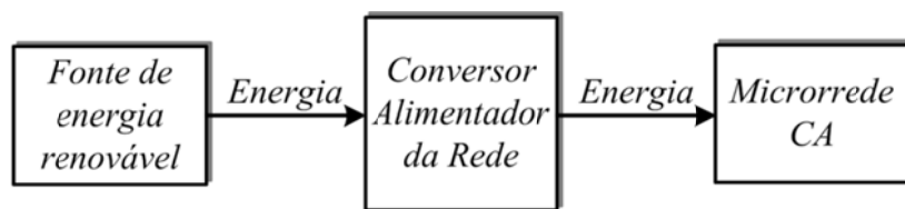
Figura 1.6 – Diagrama de blocos mostrando o fluxo de energia em um conversor alimentador da rede.
