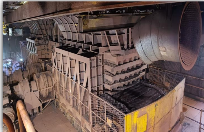
Figura 17 Vista lateral de um silo de abastecimento com um AL
