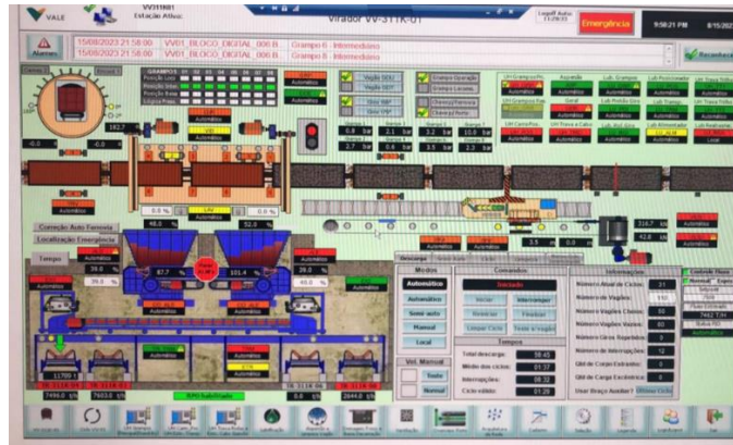
Figura 19 IHM para Operação de Virador de Vagões
