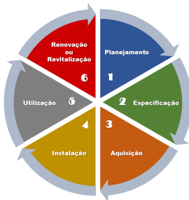
Figura 23: Etapas do ciclo de vida de um transformador de potência (elaboração própria).
