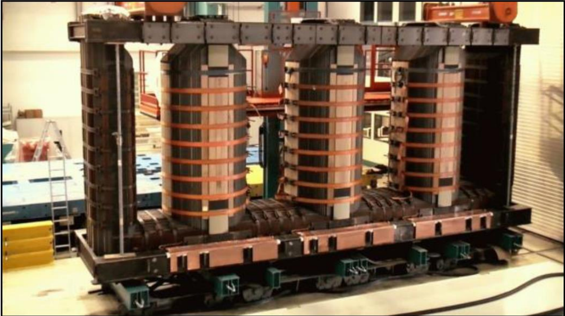
Figura 15: Núcleo de um transformador trifásico (CIGRE, 2022, p. 40).
