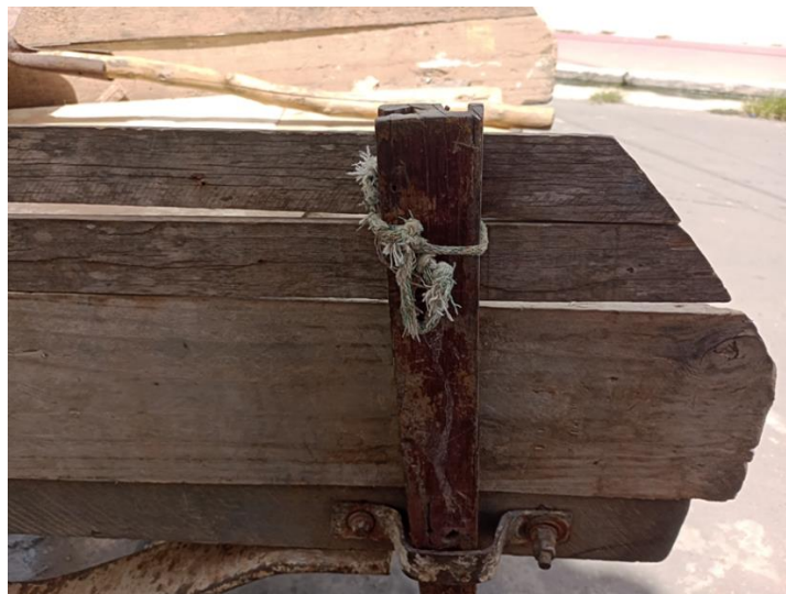
Figura 10: Visão lateral da carroça, com detalhes da estrutura de madeira, ferros e parafusos que a prendem
