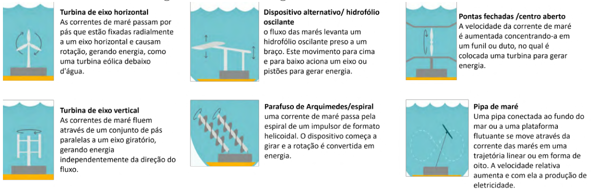
Figura 2.4: Tecnologias de correntes de maré
