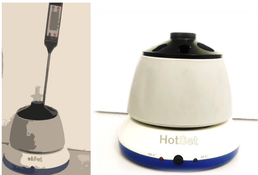
Figura 3.4.2-1 Aquecimento da resina em seringas controladas por termômetro e dispositivo de aquecimento
