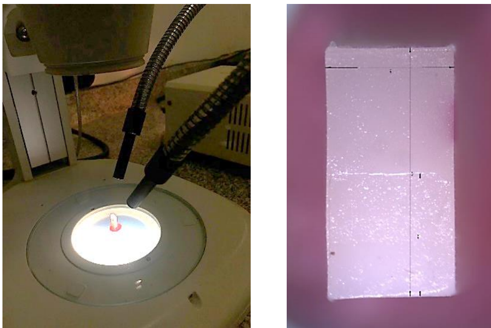
Figura 3.4.6-2 Corpo de prova levado ao microscópio para mensuração da área transversal do cp e entalhe, e imagens da área de secção da fratura, obtidas através do software UEye Cockpit
