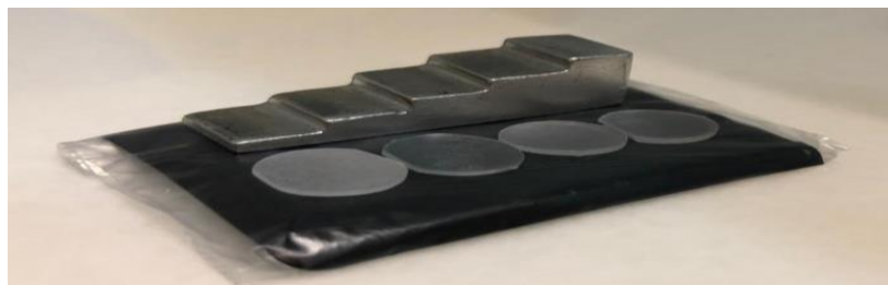
Figura 18: Penetrômetro de alumínio ao lado das amostras vítreas de borofosfato dopadas com BaO na placa de fósforo intraoral do de tamanho 2+.
