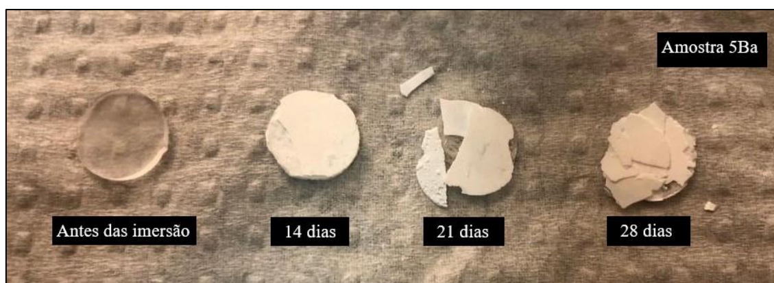
Figura 42: Foto da amostra 5Ba antes e depois da imersão em SBF. Da esquerda para a direita, Antes da Imersão, pós imersão por 14 dias, 21dias e 28 dias.
