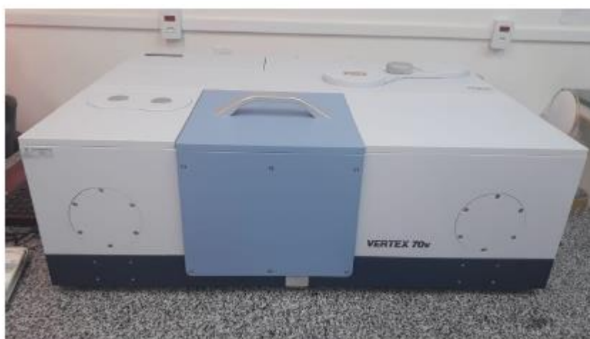
Figura 14 - Espectrômetro FTIR marca Bruker modelo Vertex 70V .
