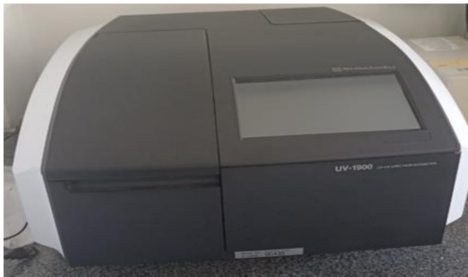
Figura 13 - Espectrofotômetro UV-Vis Shimadzu .
