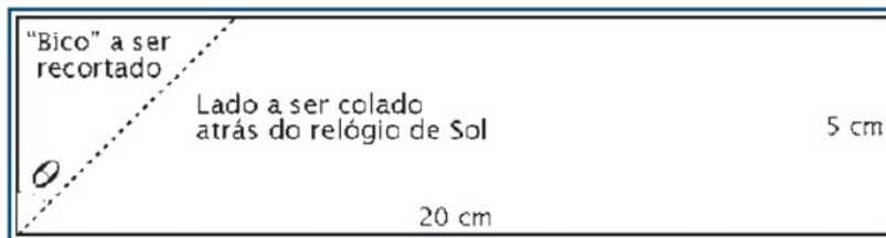
Figura 15. Indicação do “bico”, com ângulo \theta igual ao da latitude local a ser recortado. Fonte: IEMA
