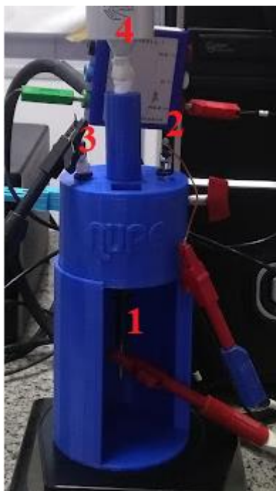
Figura 9: Imagem da célula BIA: 1) Eletrodo de trabalho CV; 2) Eletrodo de referência (Ag|AgCl, KCl 3 M); 3) Eletrodo auxiliar de platina 4) Micropipeta automática. Fonte: Autor, 2023.
