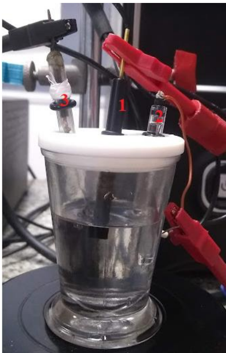
Figura 8: Imagem da célula eletroquímica: 1) Eletrodo de trabalho CV; 2) Eletrodo de referência (Ag/AgCl, KCl 3M); 3) Eletrodo auxiliar de platina. Fonte: Autor, 2023.
