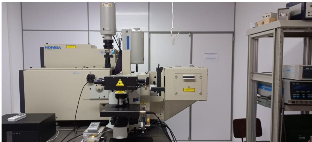
Figura: 3.3: Espectrômetro Raman Horiba/Jobin-Yvon modelo T64000, utilizado na análise vibracional das amostras.
