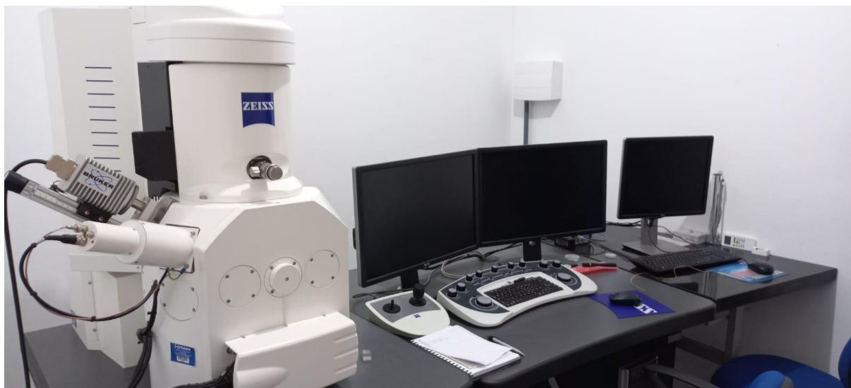
Figura 3.2: Microscópio eletrônico de varredura utilizado nas análises morfológicas dos cristais \alpha -AgVO 3 e \beta -AgVO 3 .
