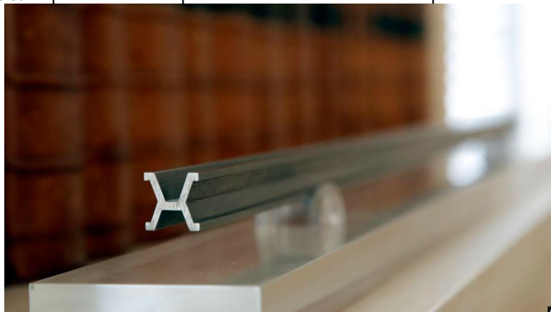
Figura 6: Réplica em “X” do padrão internacional do metro exposto na sede do BIPM.
