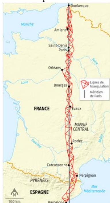
Figura 4: Linhas das triangulações (em vermelho) para medição do trecho do meridiano (em cinza) que passa por Paris.
