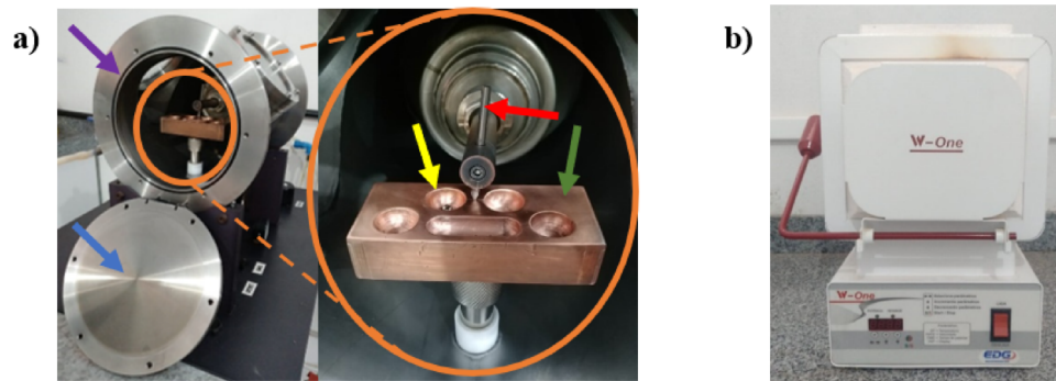
Figura 3.1: (a) Forno à arco voltaico. As setas indicam a câmara de fusão (seta lilás), o cadinho de cobre (seta verde), o eletrodo móvel de W (seta vermelha), a esfera de Ti (seta amarela) e a tampa de aço (seta azul). (b) Forno tipo mufla.
