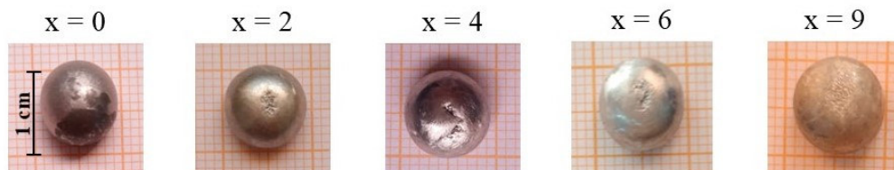
Figura 3.2: Ligas metálicas, x = 0, 2, 4, 6 e 9 , obtidas pelo método de fusão a arco voltaico.
