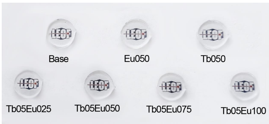
Figura 34: Foto de fatias polidas das amostras base, dopadas com Tb^{3+} , Eu^{3+} e codopadas usadas no estudo de luminescência.
