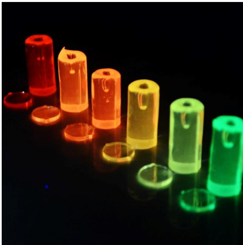
Figura 46: Foto das amostras sob luz de LED de 372 nm. Da direita para a esquerda, respectivamente Tb050, Tb05Eu025, Tb05Eu050, Tb05Eu075, Tb05Eu100 e Eu050.
